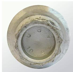
Das maximale Anzugsdrehmoment muss wie folgt festgelegt werden: **150 Nm + 180°** (Fall A)
