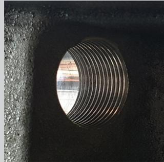
Verwenden Sie eine M22 x 1,5-mm-Gewindeschraube um vorsichtig alle Grate/ Verschmutzung im Gewinderaum des Zylinderkopfes zu entfernen.
