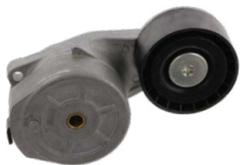
Force de la tension de 24 +/- 2,4 Nm à 28° à partir de la position de repos (bras en position libre)
