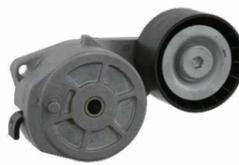
Pre-tensionamento 60 +/- 6 Nm a 50° a partire dalla posizione di riposo (free arm position)
