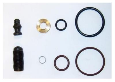
Beim Tausch des Kugelbolzens muss <u>auch</u> die Einstellschraube erneuert werden. Im Elring Dichtungssatz, Einspritzdüse 900.650 sind deshalb beide Komponenten enthalten. Eine alte und verschlissene Einstellschraube in Verbindung mit einem neuen Kugelbolzen erhöht das Risiko für einen Bruch des Kugelbolzens enorm, abgesehen von einem starken Verschleißanstieg. Bitte vermeiden Sie den Verbau einer alten Einstellschraube in Kombination mit einem neuen Kugelbolzen.
